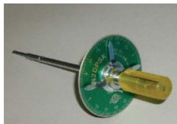
Fig. 30: Torquímetro. (Tomada de Clin Oral Implants Res. 2006 Feb; 17(1): 109-14).
